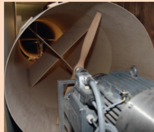
Ein 8-Kilowatt-Motor sorgt für Windgeschwindigkeiten von bis zu 80 Stundenkilometer im Windkanal
