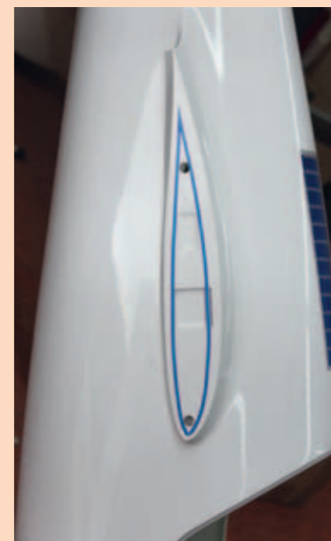
Hier das geplante Flügelprofil des neuen Quintus (blau). Das am Rumpf angeformte Profil stammt vom Nimbus 4 und ist deutlich dicker
