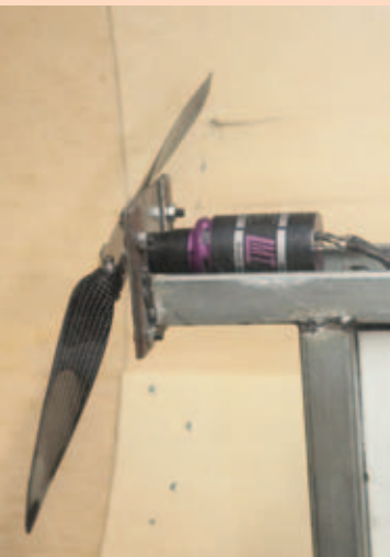
Die Motoren werden über ein stabiles Stahlgestell im Windkanal befestigt und müssen dort ihre Einsatztauglichkeit beweisen
