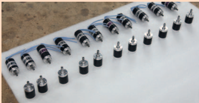
Hier warten etliche Powerline-Antriebe auf ihre „Hochzeit“ mit dem Getriebe. Das besondere dabei: Das Motorritzel wurde direkt auf die Motorwelle geschliffen
