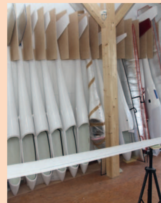
Im oberen Stockwerk des Firmengebäudes warten Arcus-Rümpfe auf ihren Ausbau
